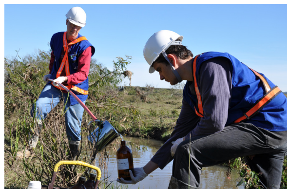
Coletas acontecem em 15 arroios ao longo dos 211 km de obra
